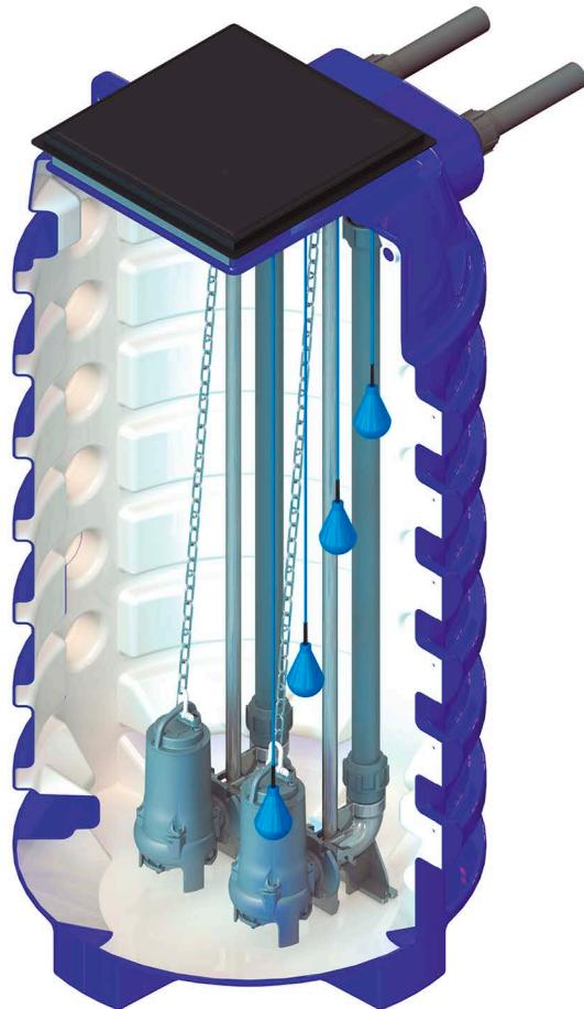
Exemplo de uso numa estação elevatória de duas bombas. Uma chave-boia é posicionada no nível de parada, uma em cada estágio de ligamento das bombas e uma no nível de extravasamento, que aciona o sistema interno o qual pode ligar/desligar a bomba ou ativar algum dispositivo de alarme.
