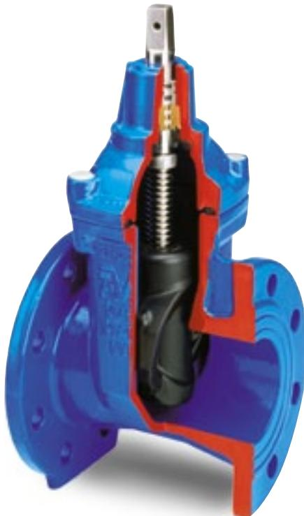
A cunha é o coração da válvula de gaveta e a qualidade da borracha da cunha é crucial para o funcionamento e durabilidade da válvula. As cunhas AVK são totalmente vulcanizadas com composto de borracha de características excepcionais. O processo de vulcanização de dupla adesivação assegura o máximo de adesão da borracha e previne a corrosão dos elementos metálicos.
